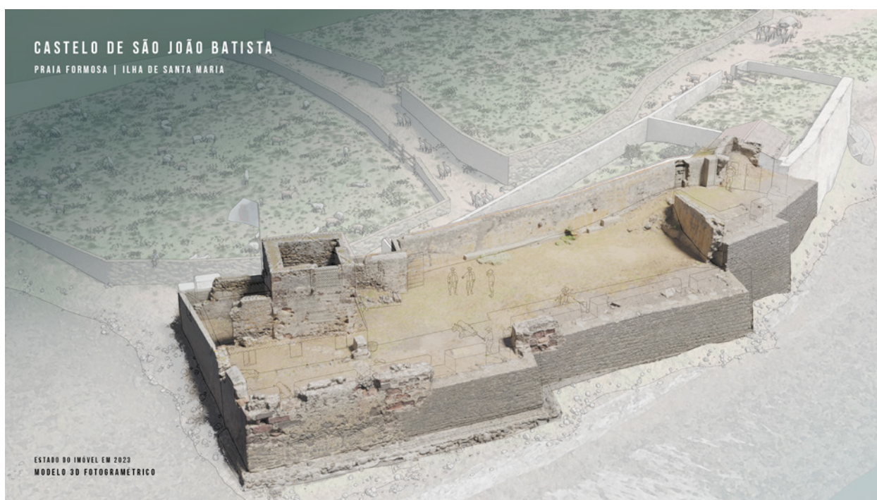
Figura 3 – Modelo fotogramétrico do Forte, com sobreposição transparente da reconstrução virtual, vista de sudoeste.
