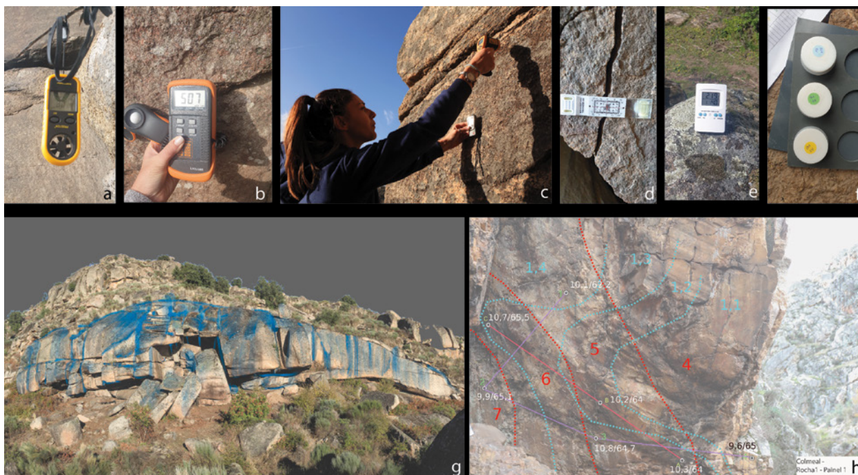
Figura 5 – Medição e monitorização dos agentes de degradação: a) medição da velocidade do vento com anemómetro; b) medição da intensidade da luz com luxímetro; c) medição de temperatura e humidade da superfície pétrea com termómetro (laser) e medidor de contacto; d) medição de movimento de fissuras com fissurómetro; e) medição da variação de T^a e H_r com termohigrómetro; f) medição de contaminantes de ar com dosímetros; g) exemplo de um mapeamento das água de escorrências no afloramento (Lapas Cabreiras); h) exemplo de um mapeamento com as medições de T^a e H da superfície do painel (rocha 1 do Colmeal).
