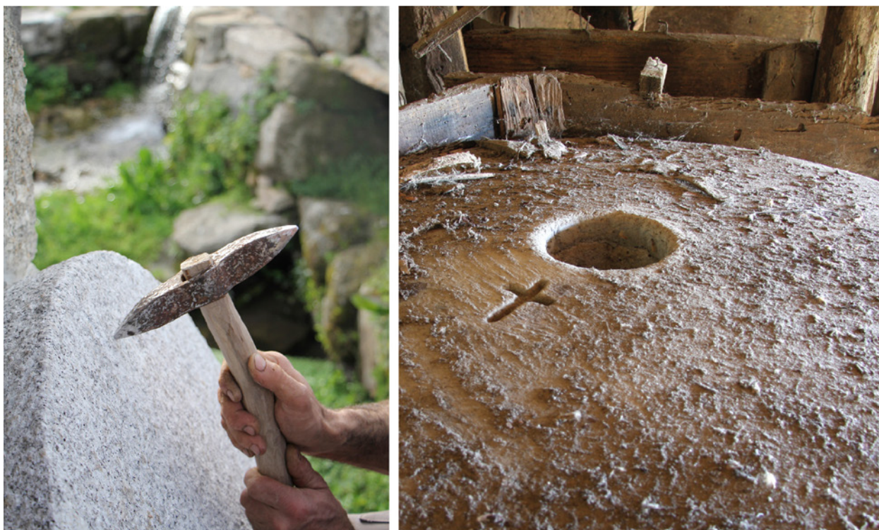
Figura 3 – A utilização do pico para picagem das mós (esquerda) foi utilizada pelos moleiros para a gravação de grafitos, inclusive nos moventes das mós (direita).
