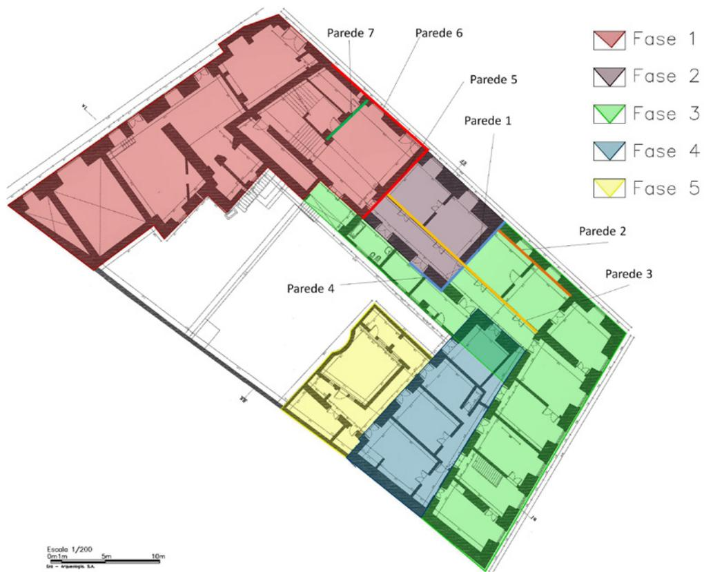
Figura 5 – Planta do edifício existente previamente à obra e seu faseamento construtivo.
