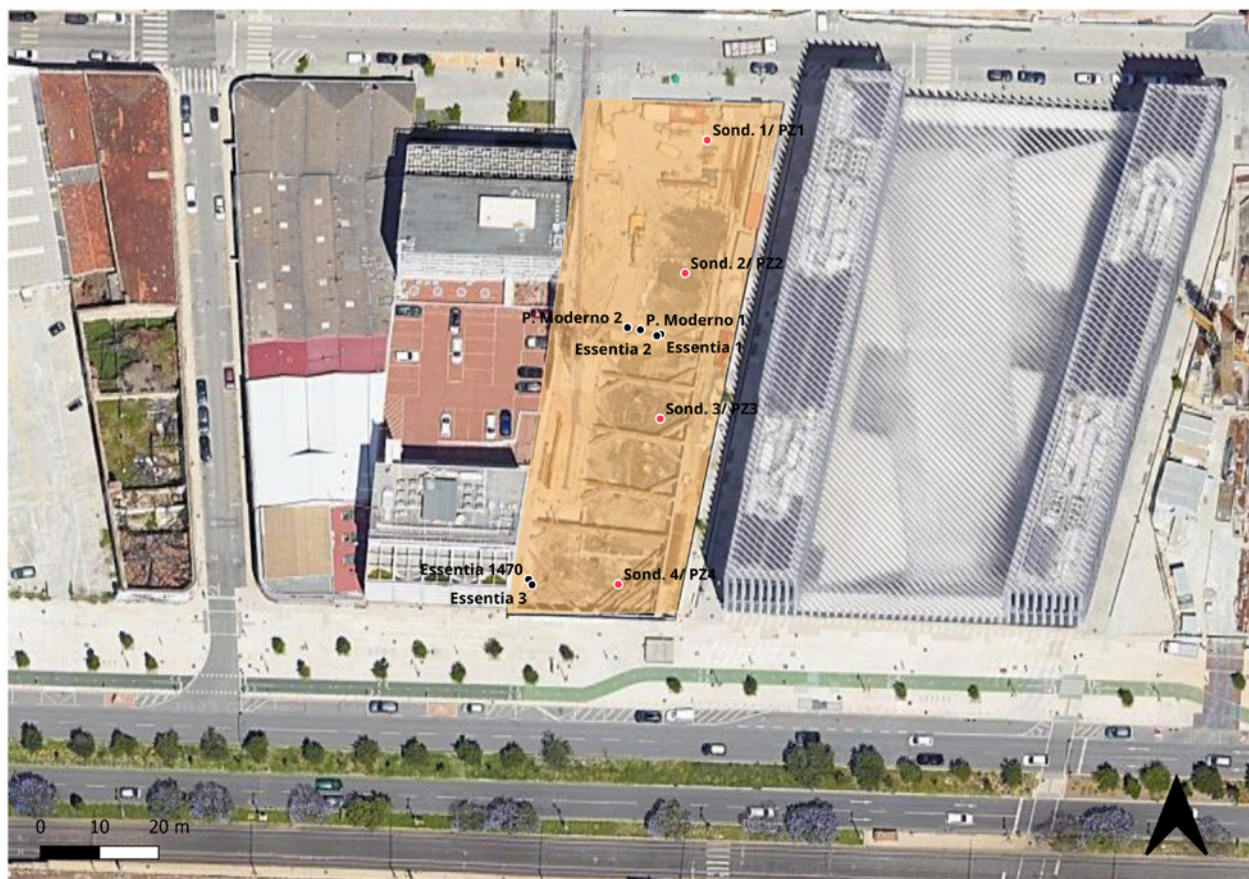
Figura 4 – Localização das sondagens de sedimentos recolhidas (círculos pretos) e das sondagens geotécnicas (círculos vermelhos) realizadas na obra da Essentia (CNS 41345). Mapa de Lisboa, QGIS versão 3.30.1.
