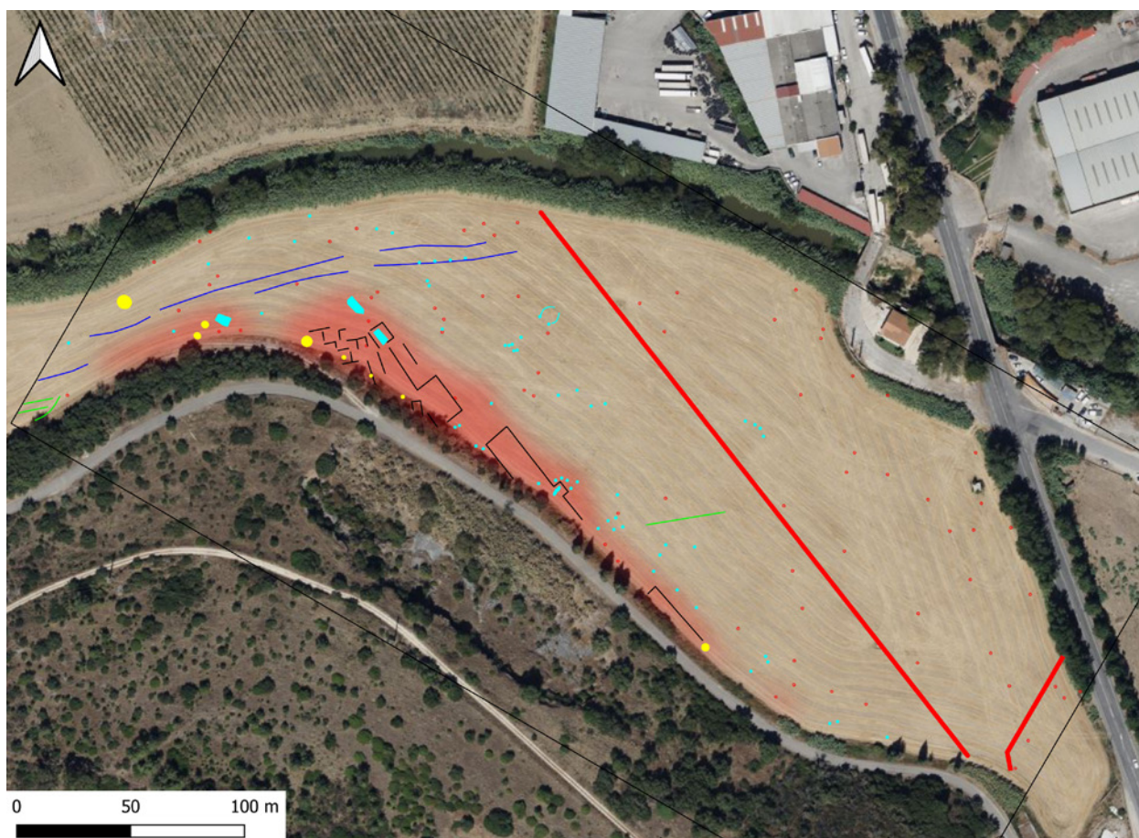
Figura 9 – Zona 5 dos trabalhos de geofísica realizada em 2021. Linha a vermelho -conduitas; Pontos vermelhos – metal; Linhas verdes – caminhos; Linhas azuis – Estruturas de contenção do leito do rio; Linha azul-clara – estruturas negativas; círculos amarelos – zonas de forno/calor intenso; linhas pretas – possíveis estruturas positivas; mancha vermelha com gradiente = zona de ruído provocada pela concentração de cerâmicas, rocha, etc de origem não local.
