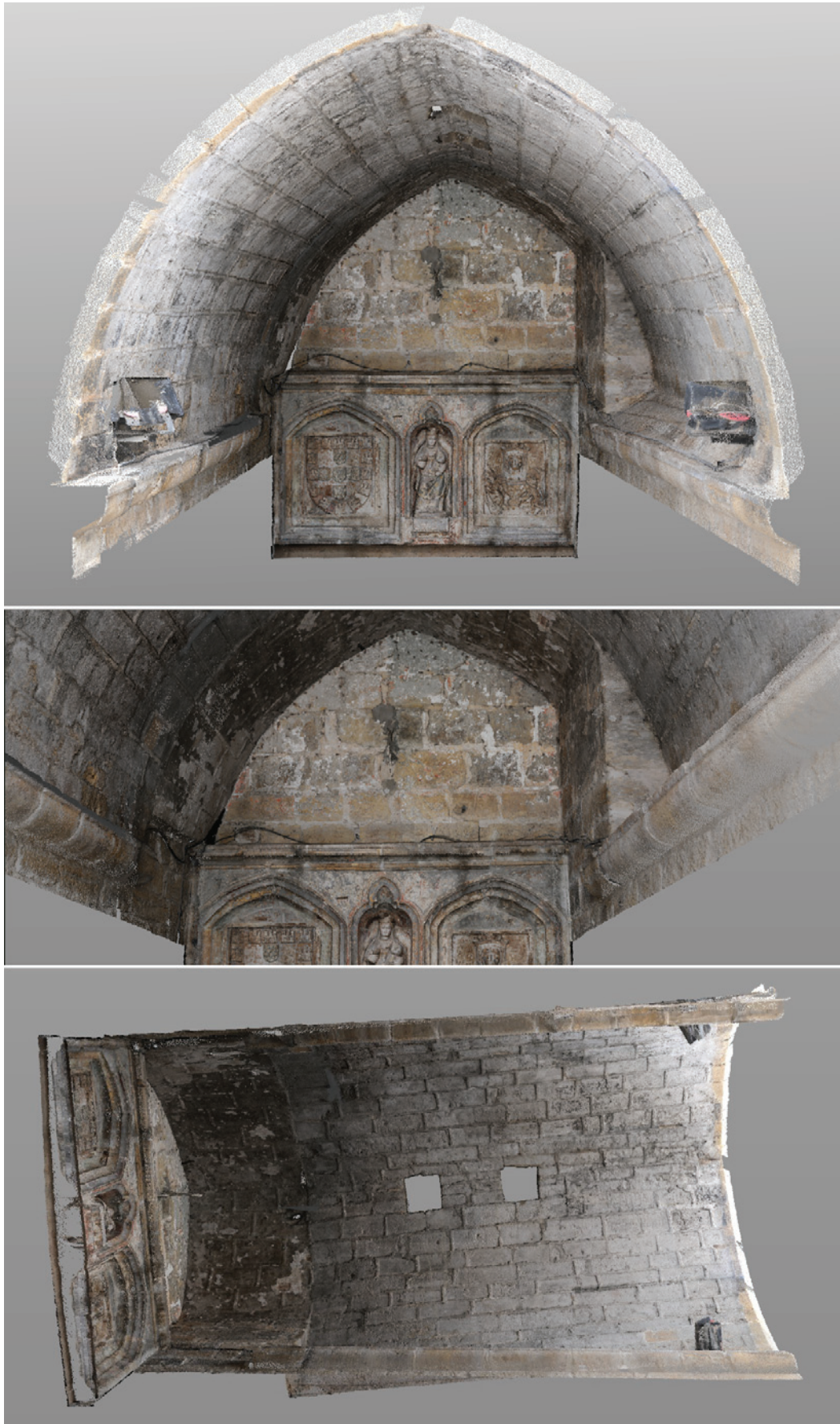
Figura 7 – Nuvem de pontos 3D coloridos da abóbada superior da Porta da Almedina (Artescan).
