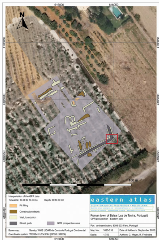
Figura 4 – Anomalias registadas por Georadar na parte nascente da Quinta de Torre d’Aires.
